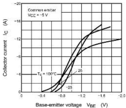
**Fig. 8.4  $I_C - V_{BE}$**
