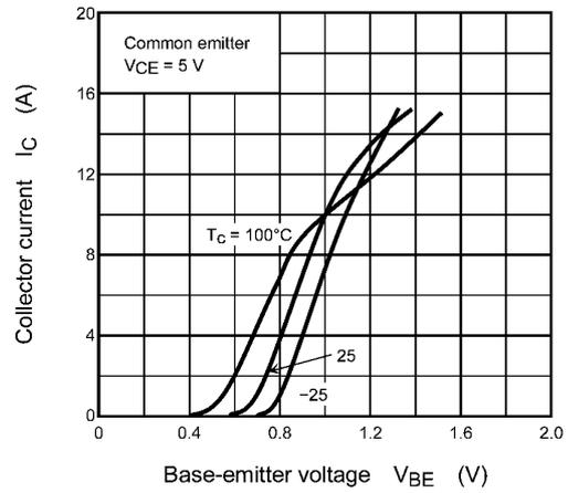
**Fig. 8.4  $I_C - V_{BE}$**
