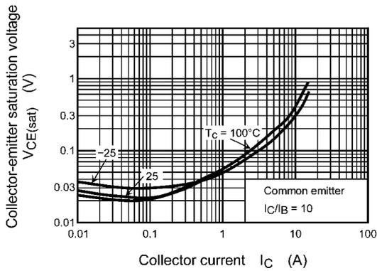
**Fig. 8.3  $V_{CE(sat)} - I_C$**
