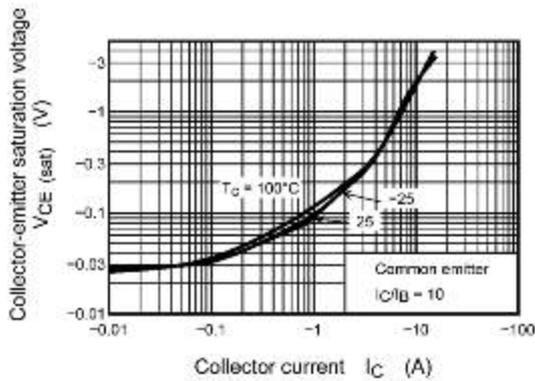
**Fig. 8.3  $V_{CE(sat)} - I_C$**
