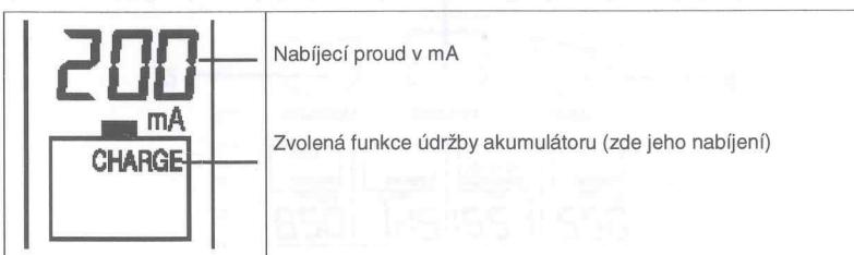
Nabíjecí proud nelze během nabíjení v příslušné nabíjecí šachtě změnit, aby nedošlo k jeho náhodnému nastavení na jinou hodnotu během provádění požadovaných nastavení pro jinou nabíjecí šachtu. Pokud bude chtít nastavit jiný nabíjecí proud, vyndejte akumulátor z nabíjecí šachty, znovu jej do ní vložte a provedte nové nastavení nabíjecího proudu. Totéž platí i pro nastavení vybijecího proudu.
