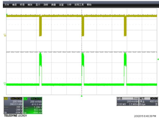
CH1:  $V_{ds}$  CH4:  $I_{inductor}$
