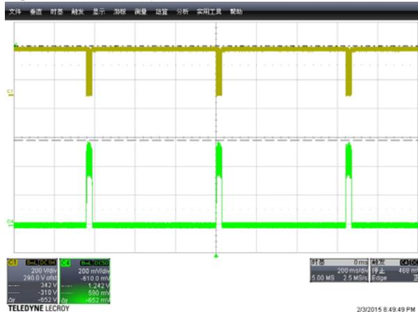
CH1:  $V_{ds}$  CH4:  $I_{Inductor}$
