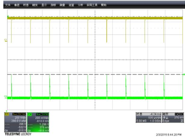
CH1:  $V_{ds}$  CH4:  $I_{inductor}$
