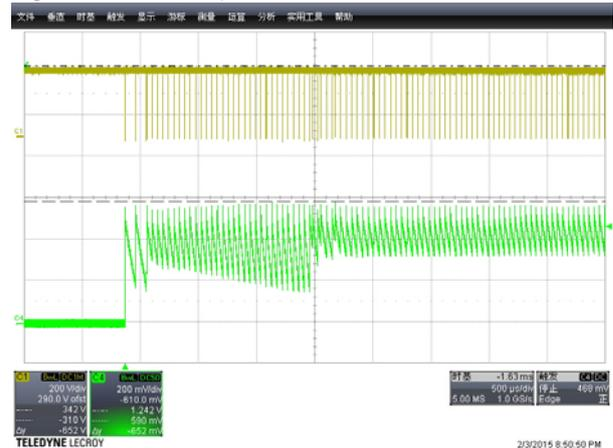
CH1:  $V_{ds}$  CH4:  $I_{Inductor}$
