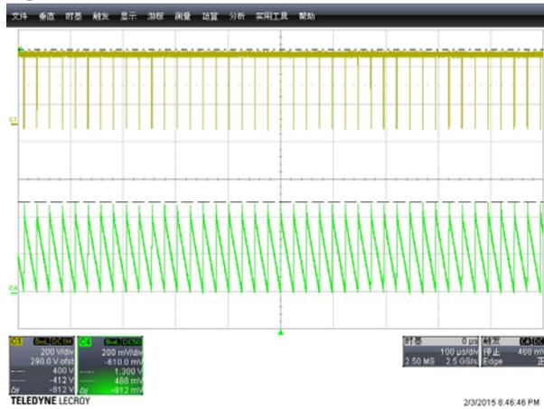
CH1:  $V_{ds}$  CH4:  $I_{inductor}$
