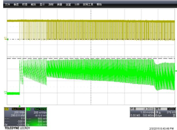
CH1:  $V_{ds}$  CH4:  $I_{Inductor}$
