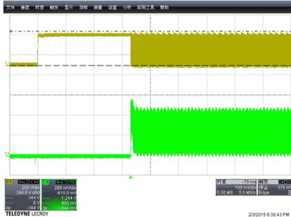
CH1:  $V_{ds}$  CH4:  $I_{Inductor}$
