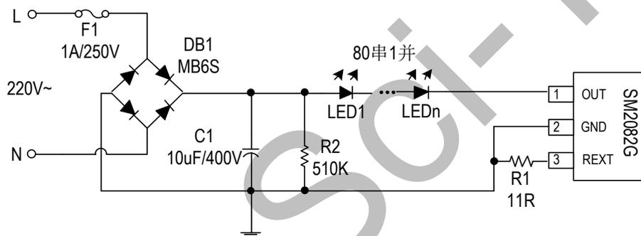
1. LED 灯串电压建议控制在 250V 到 270V 之间，系统工作最优化。
