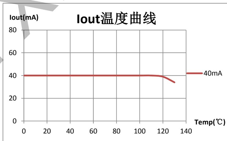
图 3. SM2082G 输出电流温度特性（注 7）
