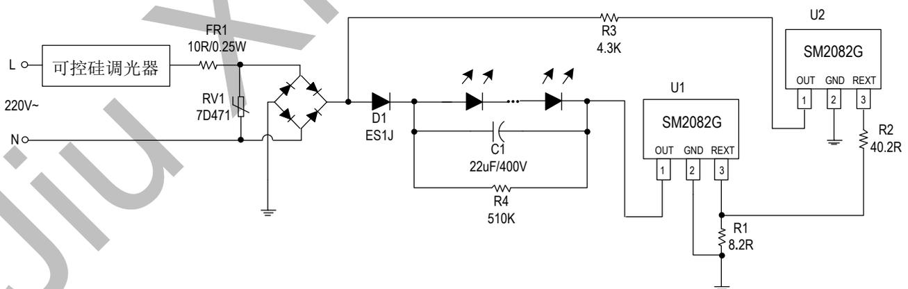
1. LED 灯串电压建议控制在 230V 到 250V 之间，系统工作最优化。
