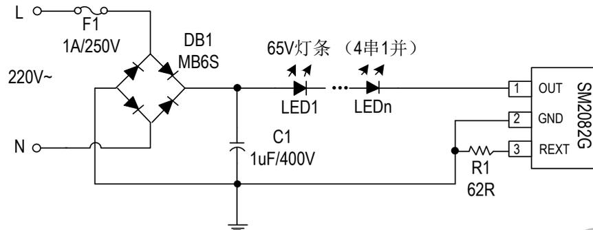
1. LED 灯串电压建议控制在 250V 到 270V 之间，系统工作最优化。
