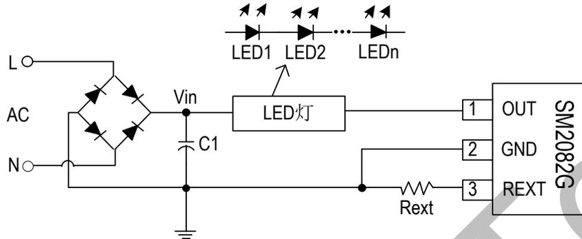
图 5 SM2082G 典型应用电路—交流电源输入
