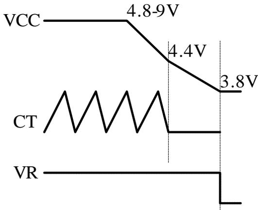
IC 内部 VCC 具有一个上限电压比较器控制，若 VCC 试图大于 10V，则比较器动作，FB 将被下拉，锁定 VCC 至 10V，达到过电压的限制功能。利用此功能可以方便地实现前端的电压反馈功能，也可避免输出开环时的输出电压大幅度升高现象，保障负载的安全。因为此特性的存在，VCC 的设计应保持在合适的范围，避免在大输出负载时 VCC 的上升过高，IC 过压限制动作导致的输出电压下降现象。
