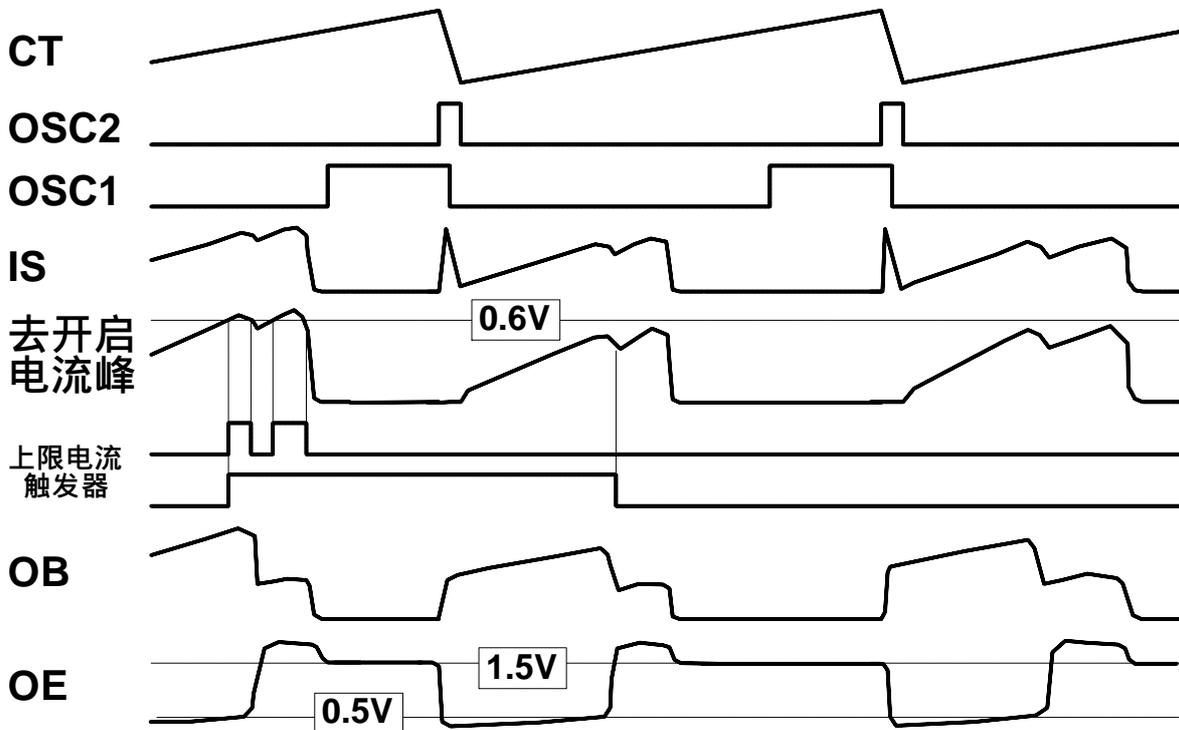
图 2. 正常阶段开关周期波形图
