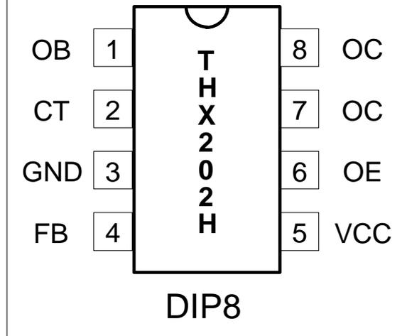
电源的可靠性。IC 内部还集成了一个 2.5V 的电压基准，为时钟电路提供精确的供电电压，而时钟频率则可由外部定时电容进行设定。
