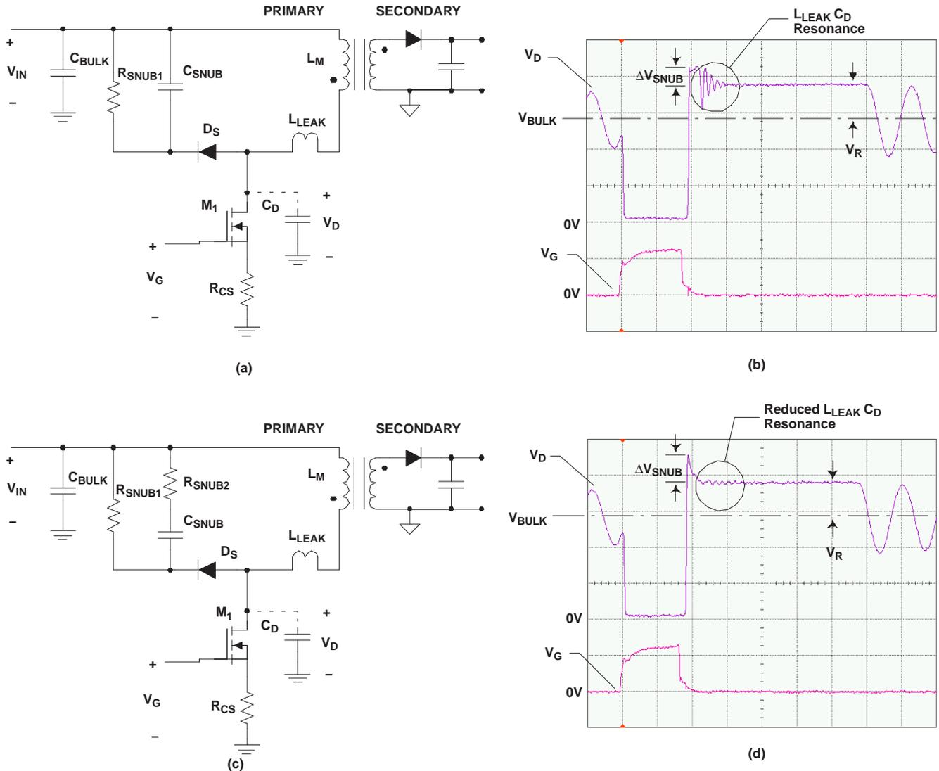
Figure 15. (a) RCD Snubber, (b) RCD Snubber Waveform, (c) R<sup>2</sup>CD Snubber, (d) R<sup>2</sup>CD Snubber Waveform
